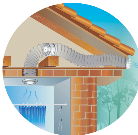
VKOk fan cottage ventilation example
