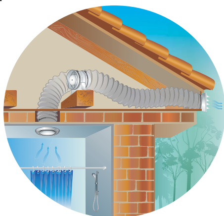
VKO1 fan cottage ventilation example
